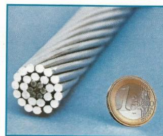
28.1 Querschnitt einer Hochspannungsleitung
